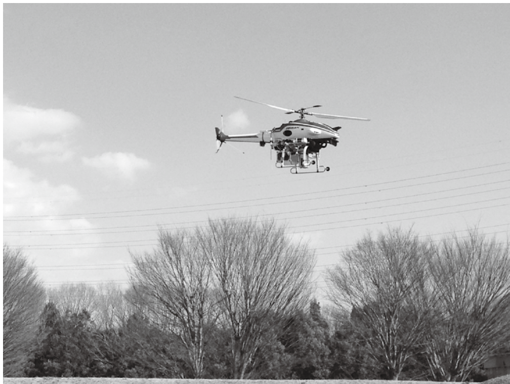
写真 変位観測システムを搭載して飛行する無人ヘリコプタ
